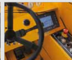
3 Painel de controle e display na cabine
