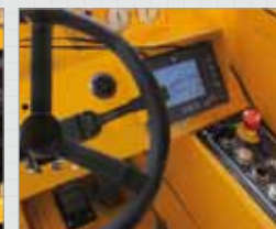
3 Painel de controle e display na cabine
